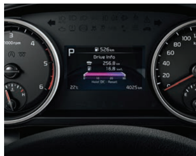
4,2-дюймовый TFT ЖК-дисплей приборной панели
