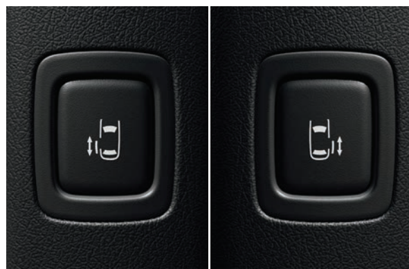
Кнопки электропривода сдвижных дверей
