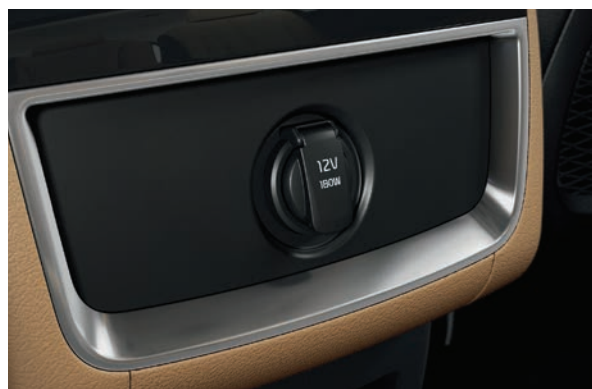
Розетка на центральной консоли
